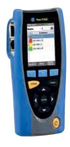
适用于PROFINET 工业的维护和故障排除 以太网以及标准以太网 IP 网络。 NaviTEK IE 旨在简化流程,识别网络 节点和配置,无需 PC 和专业软件。易于理解的系统运行状况检查可查明潜在问题 在它们成为网络故障之前。 自动发现电缆, 只需按一下按钮即可检测网络或设备配置/故障。
